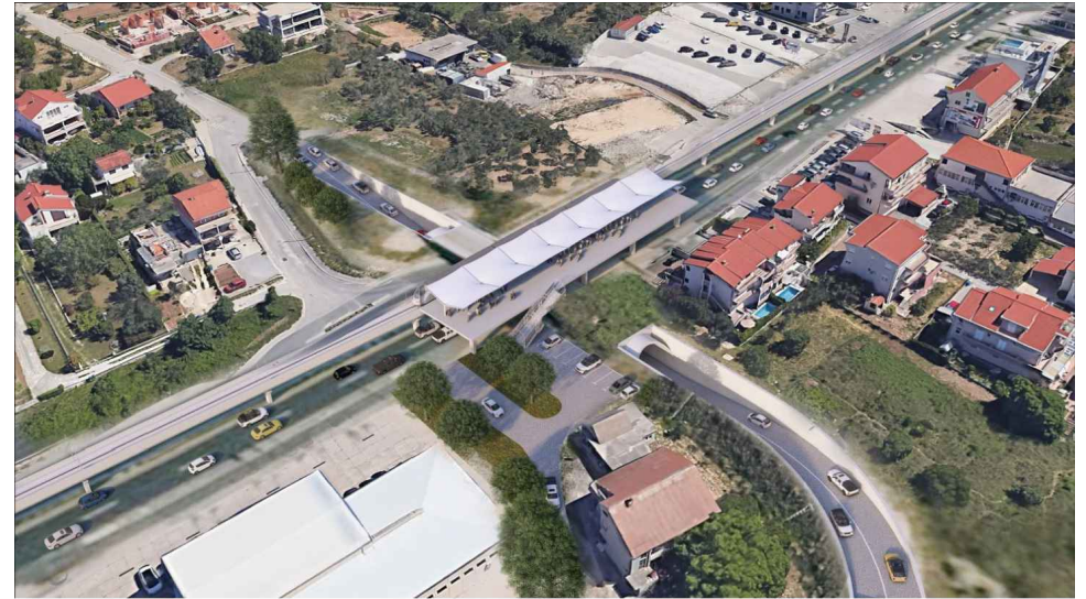
5.10 Prijedlog rješenja - stanica brze gradske željeznice Kaštel Stari s podvožnjakom za kolni promet
